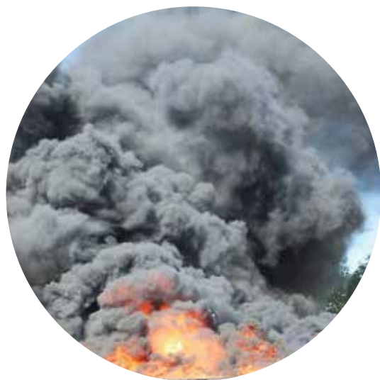
Выделение токсичных дымов в процессе натурных огневых испытаний комбинированной кровли с полимерным утеплителем на полигоне ВНИИПО
